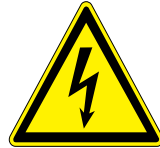
Advertencia de tensión eléctrica peligrosa
